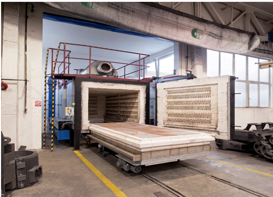
Elektrická vozokomorová žíhací pec 1150 °C, 5 t
