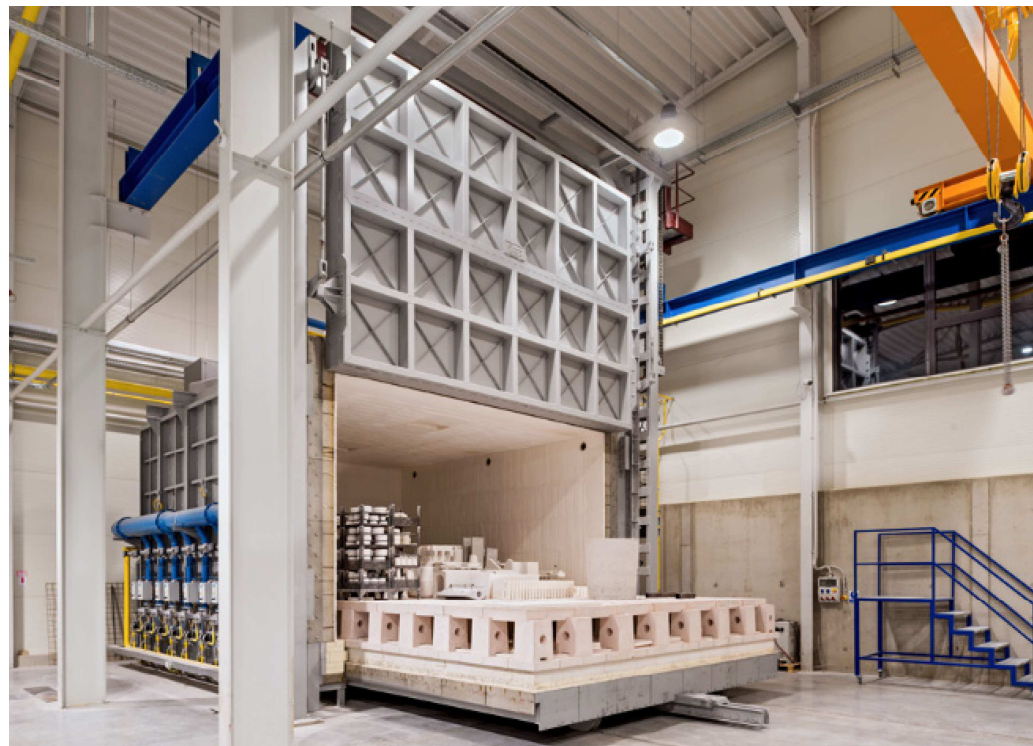
Vozokomorová pec pro výpal technické keramiky 1100 °C
